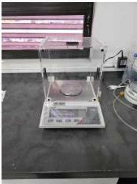
Figura 4.2: Balança Semi-Analítica MARTE modelo AD340. Fonte: A autora
