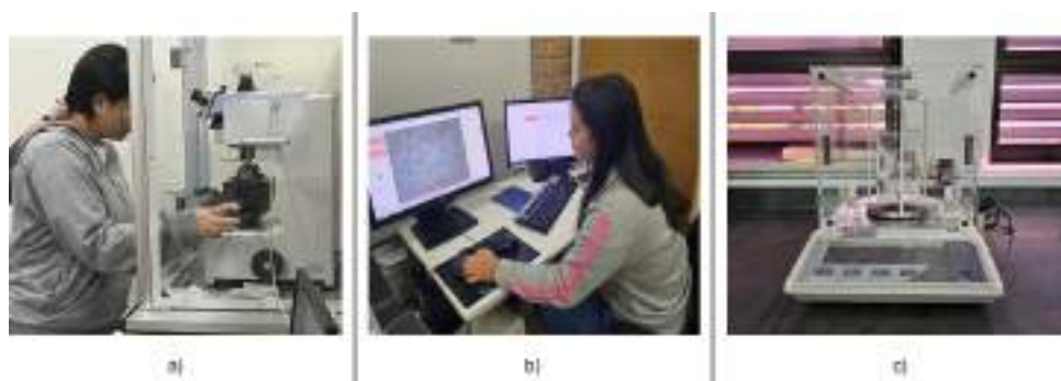
Figura 4.18: Medidas realizadas pela autora: a) microdureza Vickers; b) Topografia e rugosidade pelo microscópio confocal; c) Densidade. Fonte: A autora
