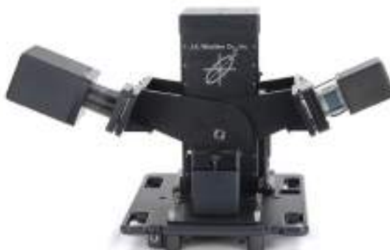
Figura 4.7: Elipsômetro J.A. Woollam, modelo M-200. Fonte:( J.A. Woollam Co., Inc., 2025 )
