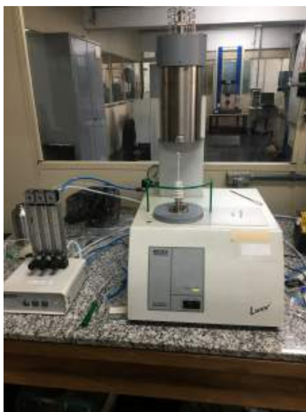
Figura 4.9: Analisador Térmico Netzsch STA 409 PC Luxx. Fonte: A autora
