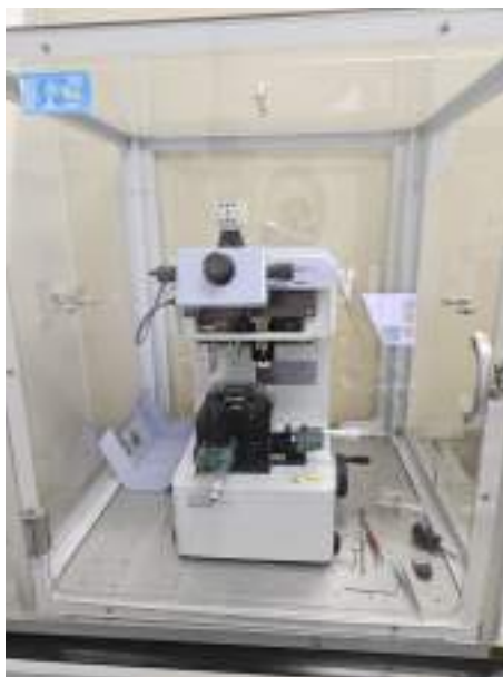
Figura 4.8: Ultramicrodurômetro DUH-211s. Fonte: A autora
