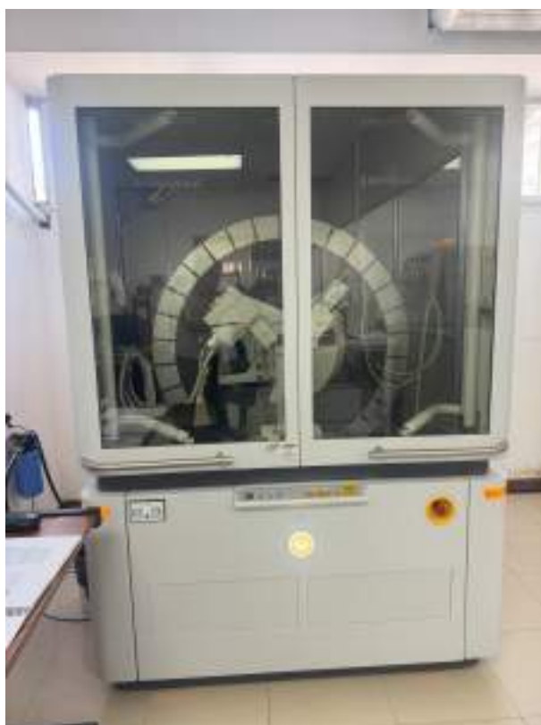
Figura 4.10: Sistema Gerador/Difratômetro X'Pert Pro da marca Philips, Panalytical.
