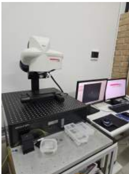
Figura 4.4: Microscópio Confocal Interferométrico Leica DCM 3D. Fonte: A autora
