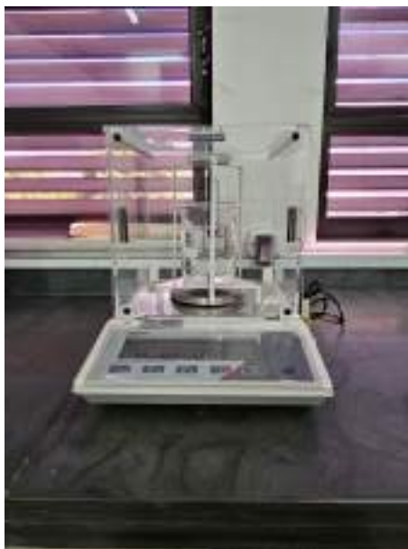
Figura 4.6: Balança Semi-Analítica MARTE modelo AD340 com o Kit hidrostático MARTE. Fonte: A autora
