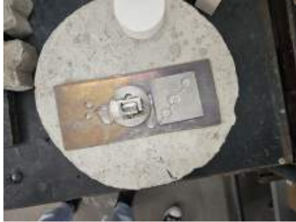
Figura 4.16: Resultado final da síntese no terceiro teste, mostrando a possibilidade de obtenção das amostras via micro-ondas. Fonte: A Autora
