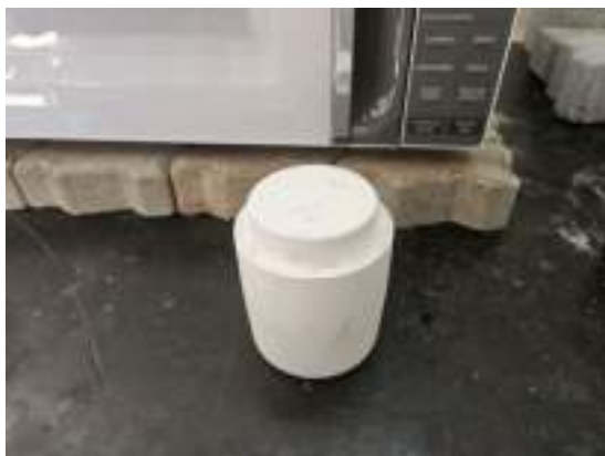
Figura 4.13: Visão lateral do esquema dos cadinhos com a nova tampa. Fonte: A Autora
