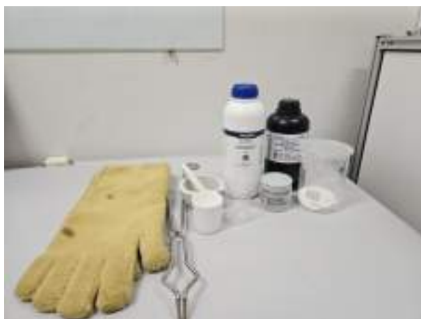
Figura 4.1: Luvas de alta temperatura, tenaz, cadinho de cerâmica, reagentes químicos e béquer. Fonte: A autora
