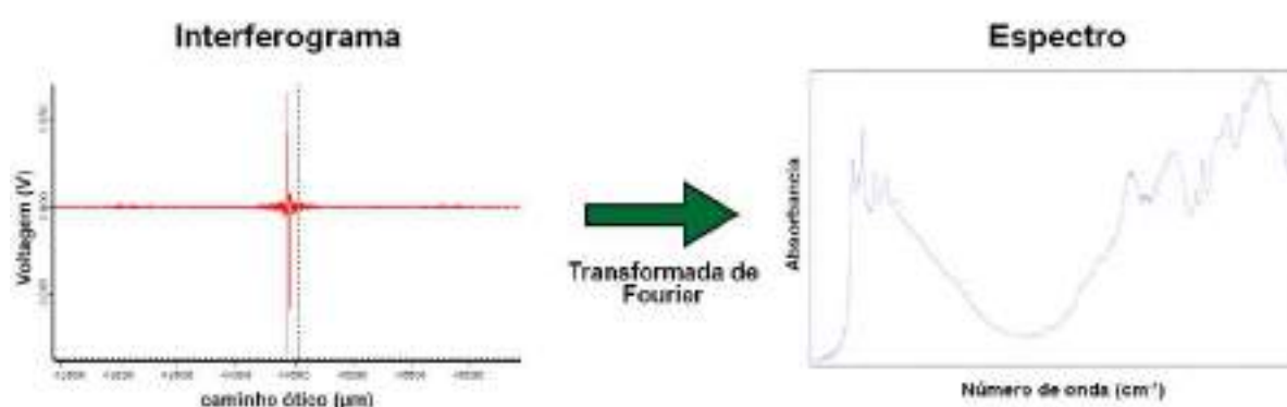
Figura 2.8: Ilustração de um interferograma, usado na obtenção de um espectro de absorbância em função do número de onda para a caracterização de microplásticos. Retirado de (Cardoso, 2018).
