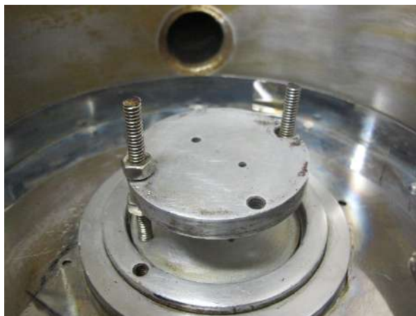
Figura 14 – Imagem da montagem do catodo oco
