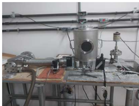
Figura 11 – Imagem do sistema de deposição PECVD para produção de filmes PLC
