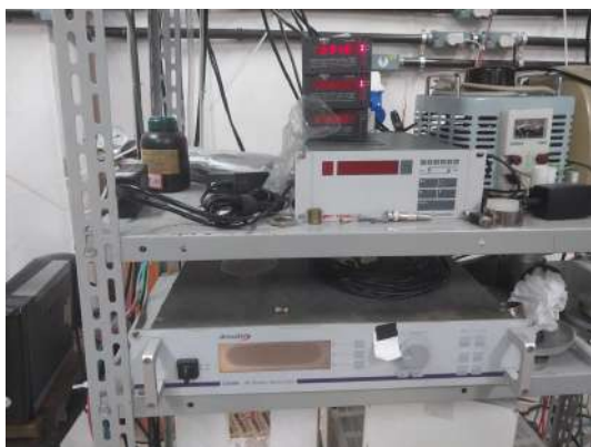
Figura 11 – Imagem do sistema de deposição PECVD para produção de filmes PLC
