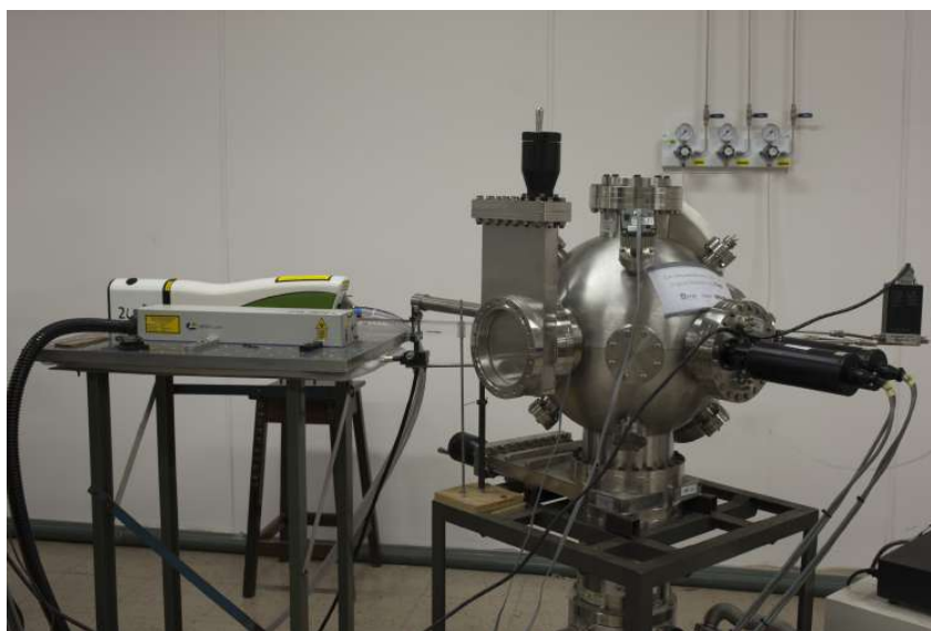
Figura 6.2.1 – Aparato experimental para produção de nanopartículas por PLD
