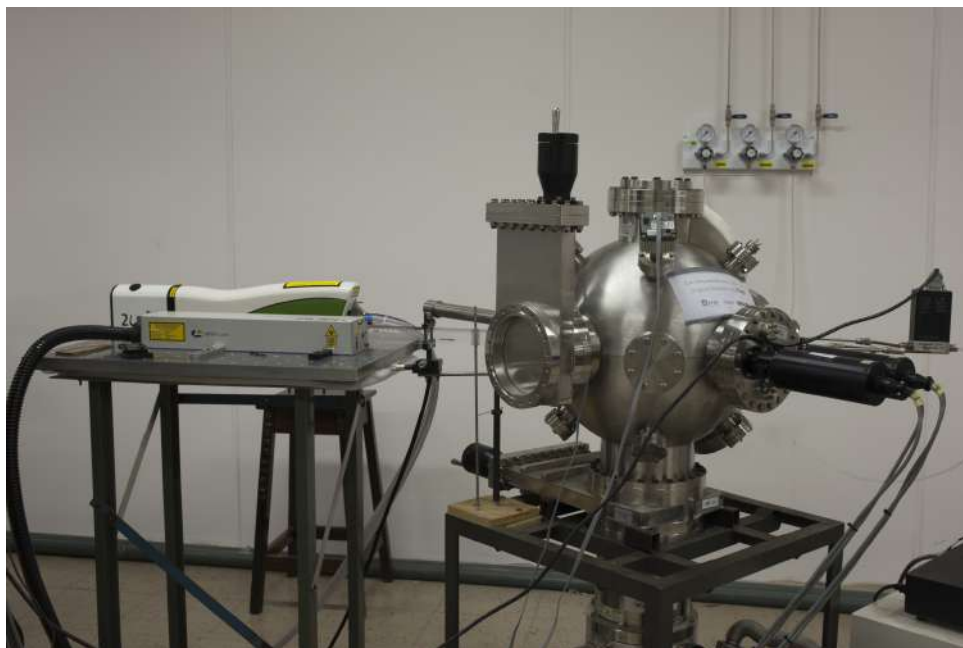
Figura 8.2.1 – Aparato experimental para produção de nanopartículas por PLD
