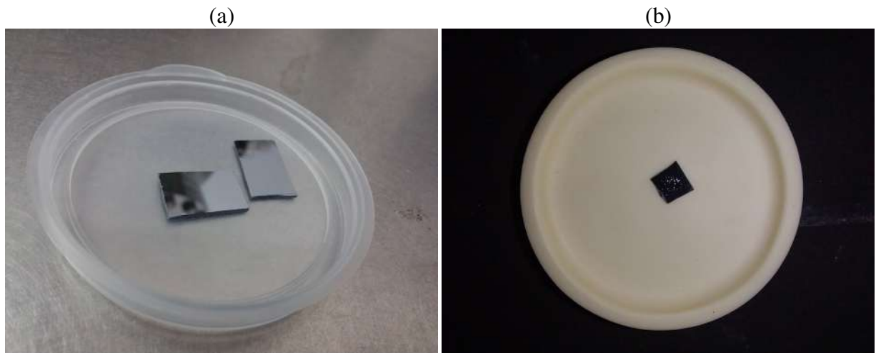
Figura 8.2.2 – Substrato de Silício sem deposição de nanoestrutura (a) e com deposição (b).
