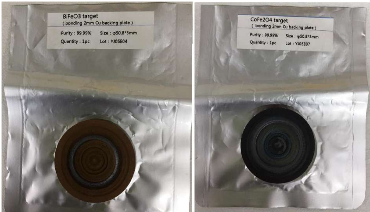
Figura 3.4: Alvos comerciais utilizados nesse trabalho (BFO à esquerda e CFO à direita), ambos com diâmetro de 51 mm e pureza de 99,99 %.
