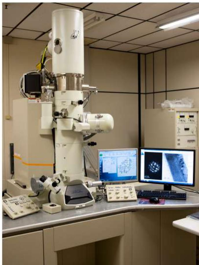
Figura 3.10: Microscópio de transmissão, JEOL JEM 2100F do laboratório LaMAR IF-UFF.
