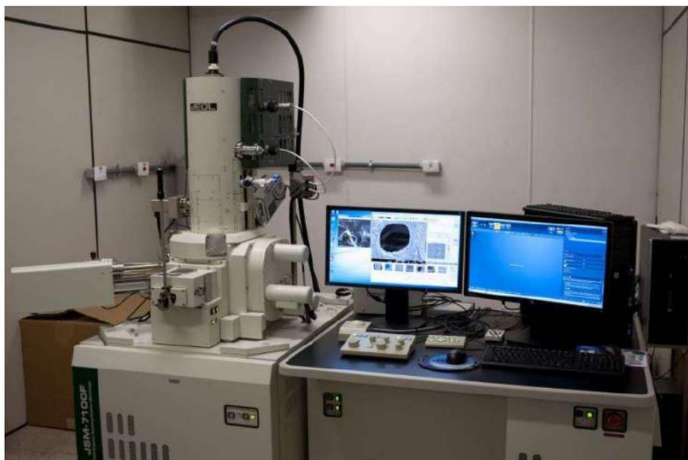
Figura 3.6: Microscópio eletrônico de varredura JEOL, modelo JSM 7100F laboratório LaMAR IF-UFF.
