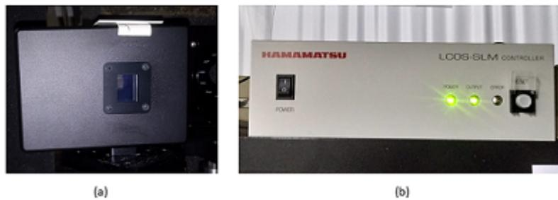
Figura 15 – (a) Dispositivo SLM com destaque a sua tela de cristal líquido. (b) central de acionamento do SLM. Fonte: Autor
