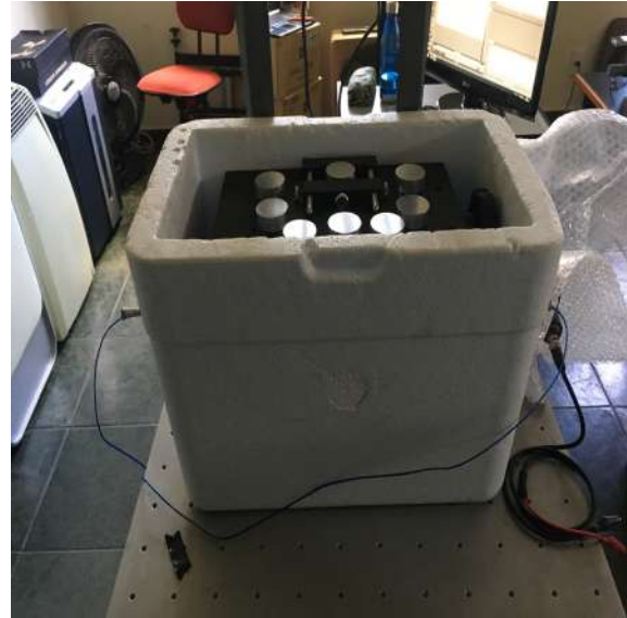
(b) Destaque para distribuição das amostras na caixa de isopor.
