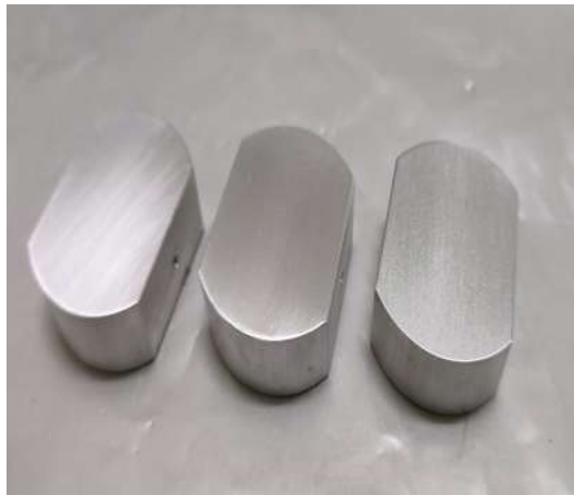
Figura 3.1: Amostras de alumínio comercial com diferentes rugosidades de superfícies.
