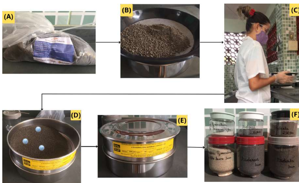
Figura 4.2: Procedimento Experimental utilizado no peneiramento das escórias.
